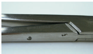
鉗子側面に発生した孔食錆
