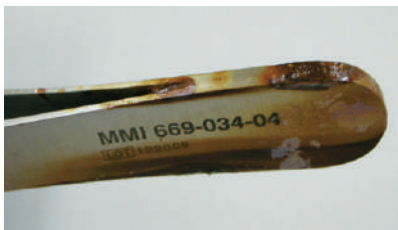
生理食塩水による不適切なすすぎにより発生した錆
