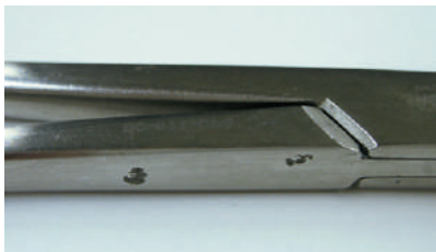
鉗子側面に発生した孔食錆
