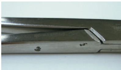
鉗子側面に発生した孔食錆
