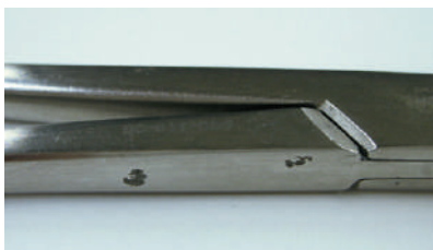
鉗子側面に発生した孔食錆
