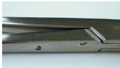
鉗子側面に発生した孔食錆
