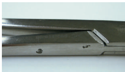
鉗子側面に発生した孔食錆
