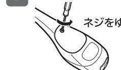
2 電池カバーを取り外し、細くて折れにくい棒で電池を取り出す
