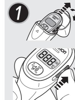
体温計を収納ケースから取り出し、電源スイッチを押し上げて、電源を入れる
