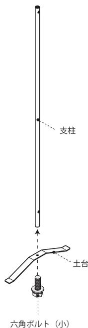
②下図のように生地を両端に丸パイプを通し、支柱と丸パイプを組み立ててください。
