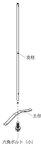
※ボルトを締め付ける際は、支柱と丸パイプの隙間を無くしガタつかない程度に締め付けてください。ボルトを締めすぎると支柱が変形する可能性があります。
