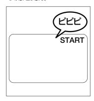
4.ピピピと音が し、表示部に 「START」が 表示される。
