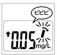
6.ピピピと音がして測定結果と換気お知らせサインが約4秒間表示される。
