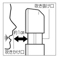
5.吹きかけ口か ら1cm程度離し て約4~5秒 間息を吹きか ける。 ピピピと音がし たら、測定完了
