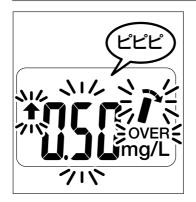
③測定結果で上 限数値を超え るとピピピと音 がし、「**OVER**」 点滅する。
