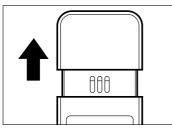
1.センサーキャッ プを引き上げ て電源をON する。
