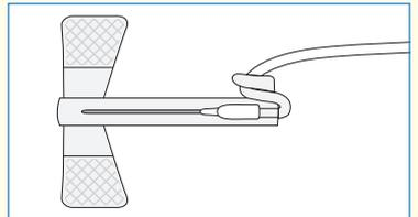
針を収納した後、ウイング後方にある液ダレ防止ストッパーにチューブを挟み (閉塞)、使用後の液ダレ、飛沫軽減にご利用ください。
