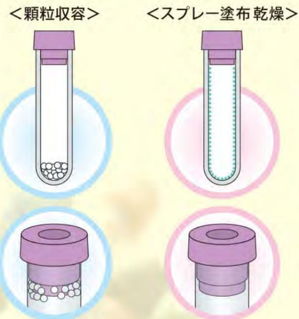
採血管に入れる抗凝固剤は従来の顆粒タイプに加えてスプレーコーティングタイプも選びいただけます。
