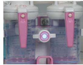
運転スイッチを「ON」にすると、ボトルレバーのLEDが点灯し作業中であることをお知らせします。
