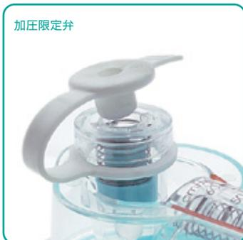
**A** 加圧限定弁は限定圧力(60cmH<sub>2</sub>O)に達すると弁が開き、余剰圧力を放出し肺損傷のリスクを軽減します。また、より高い圧力が必要な時はキャップを閉じることで加圧限定弁を機能させずに換気できます。
