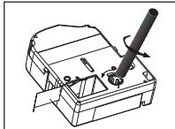
2. 製品は垂直にラベルライターにセットしてください。セットの際ラベルの先端をラベルライターのラベル出口に合わせてセットしてください。
